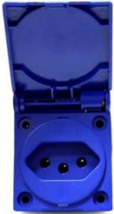
Deverão ser utilizadas tomadas com o diâmetro (4 mm), para aparelhos com corrente nominal de até 10 ampères e os plugues de (4,8 mm) , para equipamentos que operam com mais de 10 Aamprese em até 20 ampères. Essa distinção se fez necessária para garantir a segurança, pois evita a ligação de equipamentos de maior potência em um ponto não especialmente projetado para essa ação.
