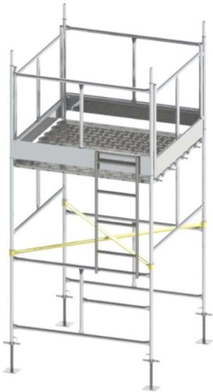
Para andaime simplesmente apoiado construído em torre única com altura inferior a 4 (quatro) vezes a menor dimensão da base de apoio, fica dispensado o projeto de montagem, devendo, nesse caso, ser montado de acordo com o manual de instrução do fabricante.
